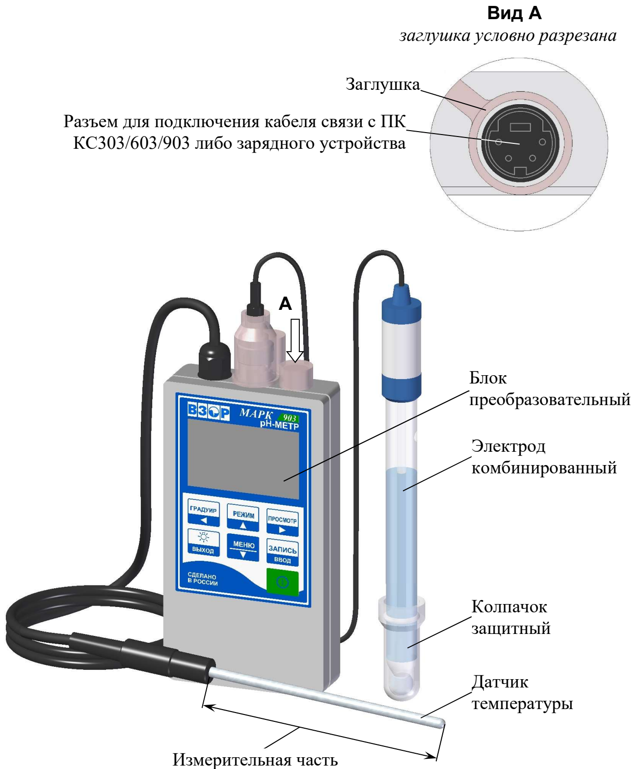
Рисунок 1.1 – pH-метр МАРК-903 (вид спереди)
