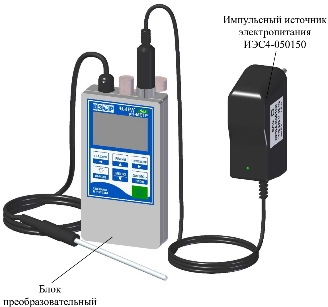
Рисунок 3.1 – Зарядка аккумуляторных батарей
