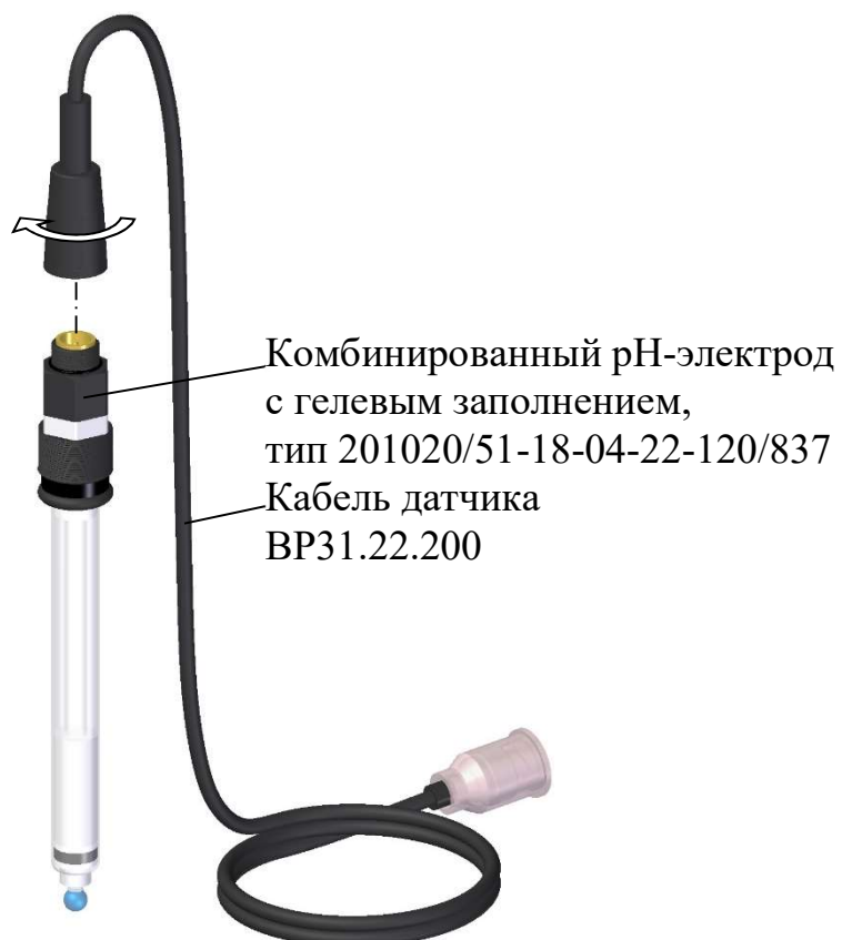
Рисунок 2.2 – Подсоединение кабеля датчика ВР31.22.200 к электроду
