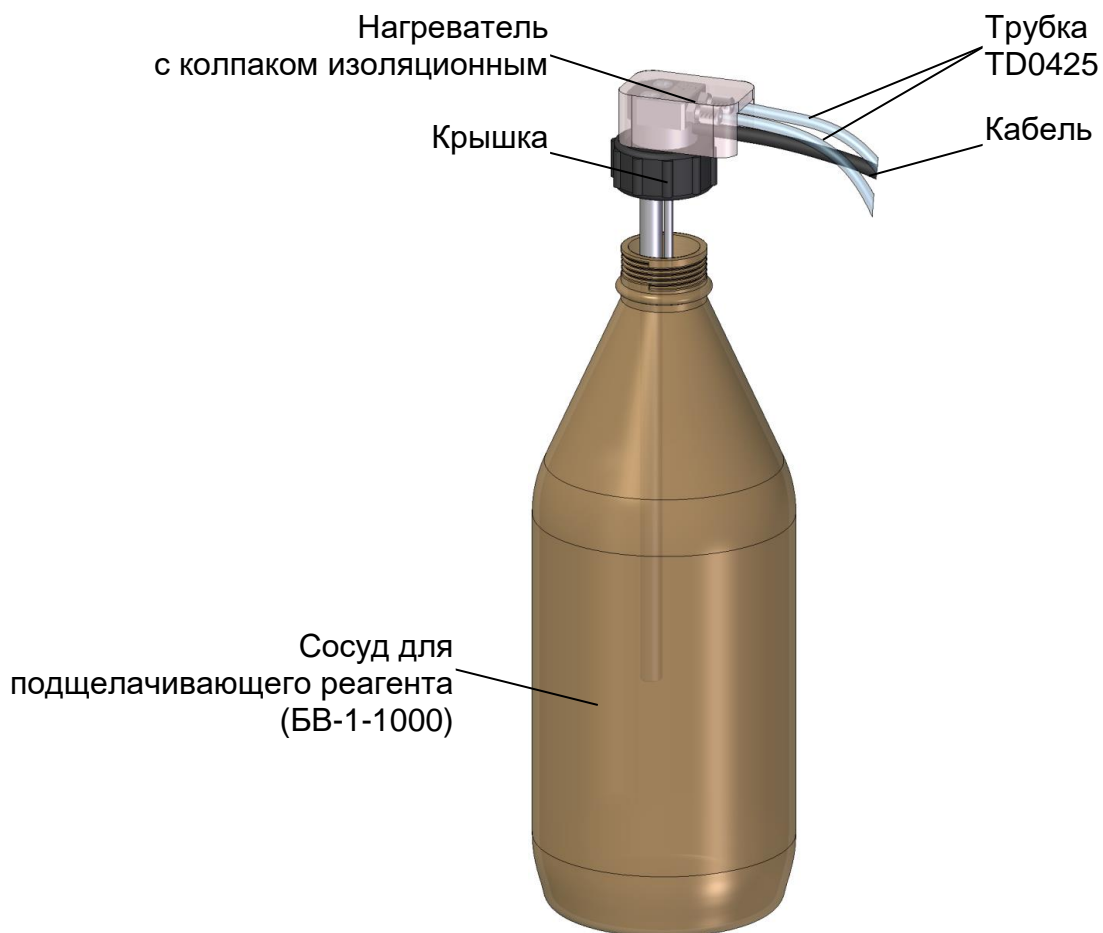
Рисунок 2.13 – Заливка подщелачивающего реагента в сосуд гидропанели ГП-1002Т
