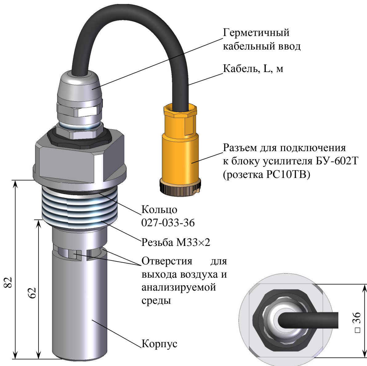
Рисунок 1.6 – Датчик проводимости ДП-003Т
