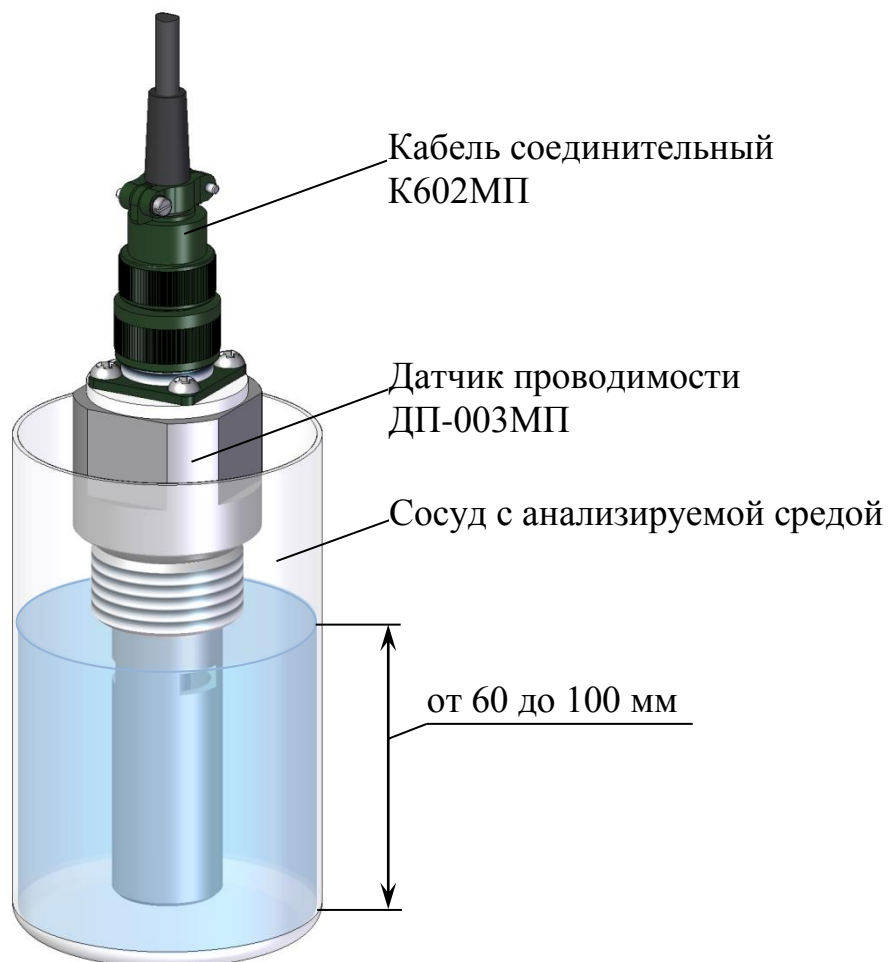
Рисунок 2.8 – Расположение датчика проводимости ДП-003МП в сосуде
