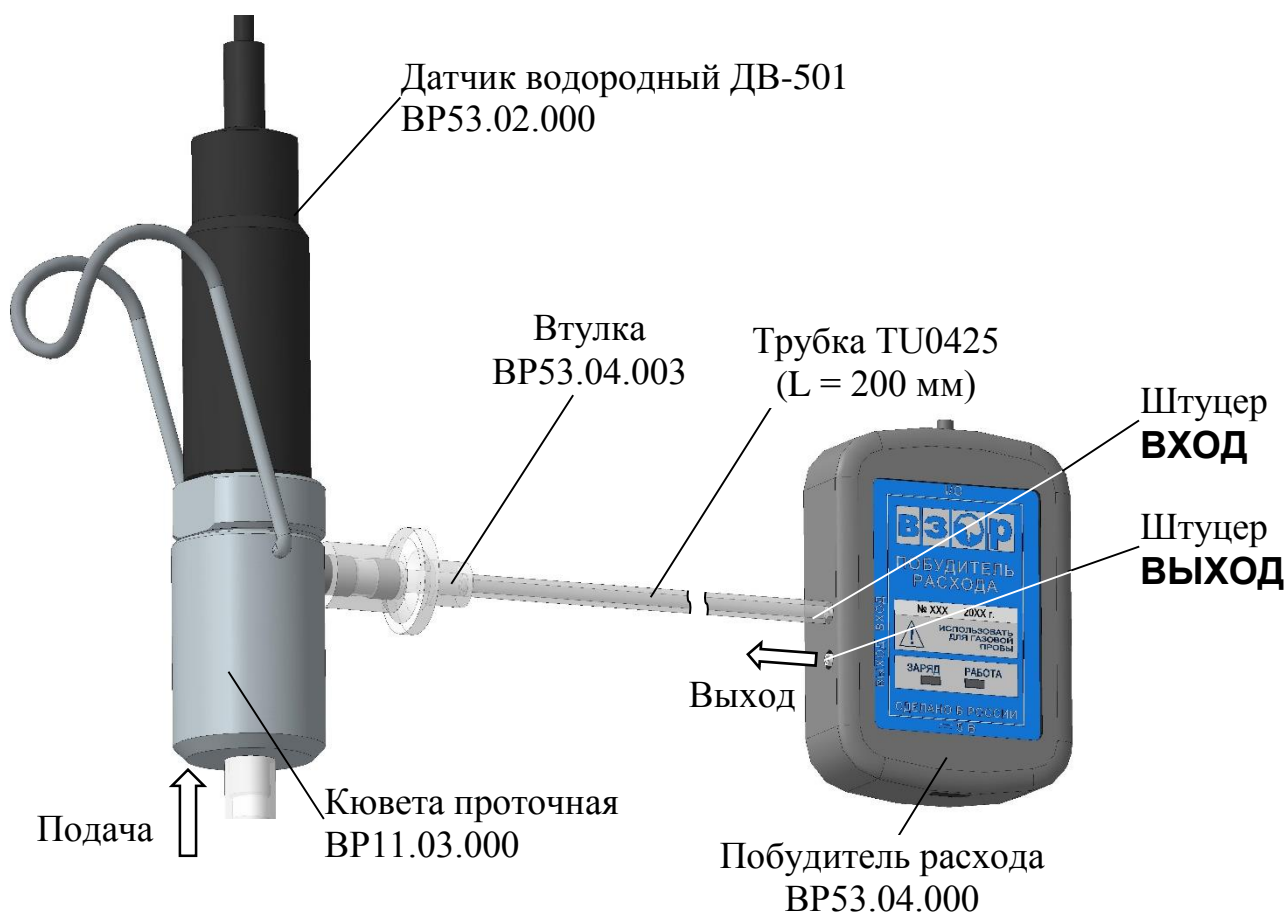
Рисунок 2.7–Проведение измерений с использованием побудителя расхода BP53.04.000
