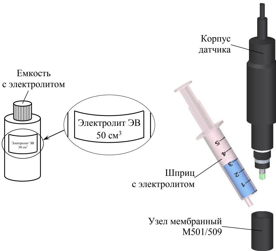
Рисунок 2.2 – Заполнение датчика электролитом
